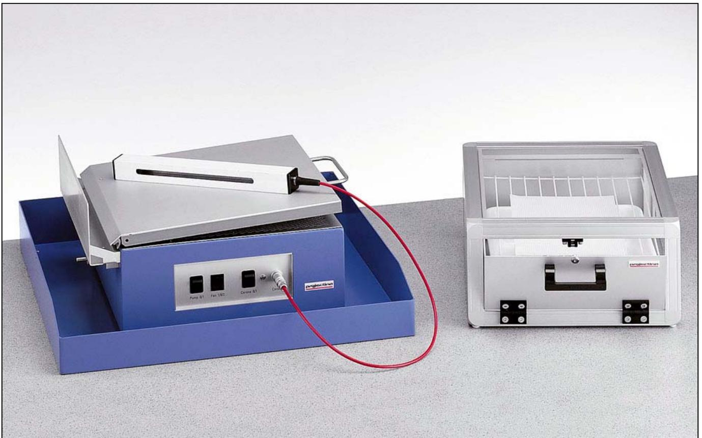
Aufgrund der recht grossen Abmessungen der Untersuchungseinheit (430x430 mm) ist das Docustat DS-210 System für kleine und grosse Untersuchungsobjekte einsetzbar. Die mitgelieferten Plastikfilme, Typ IW und SP, erlauben den Einsatz des Systems für verschiedene Anwendungen wie: Sicherung von Schrifteindruckspuren (Rillen) sowie das Festhalten von Schuhabdrücken auf papierartigen Oberflächen.
